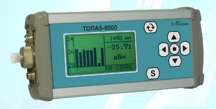
Оптический анализатор **ТОПАЗ-8000** предназначен для измерения и контроля мощности при запуске и в процессе эксплуатации CWDM сетей. Все 16 (18) каналов соответствуют требованиям ITU-T G.694.2. Результаты измерений могут отображаться как графическим способом, так и в виде таблицы, а также передаваться на компьютер, для подготовки отчета.
