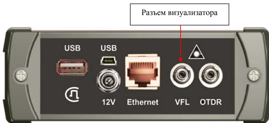
Рис. 37. Подключение ОВ к VFL
