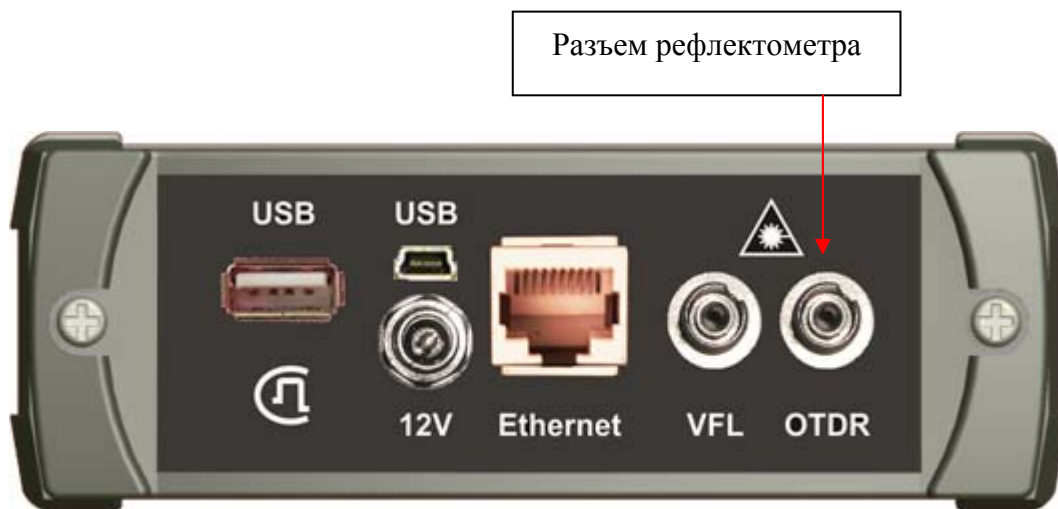
Рис. 40. Подключение оптического волокна к OTDR
