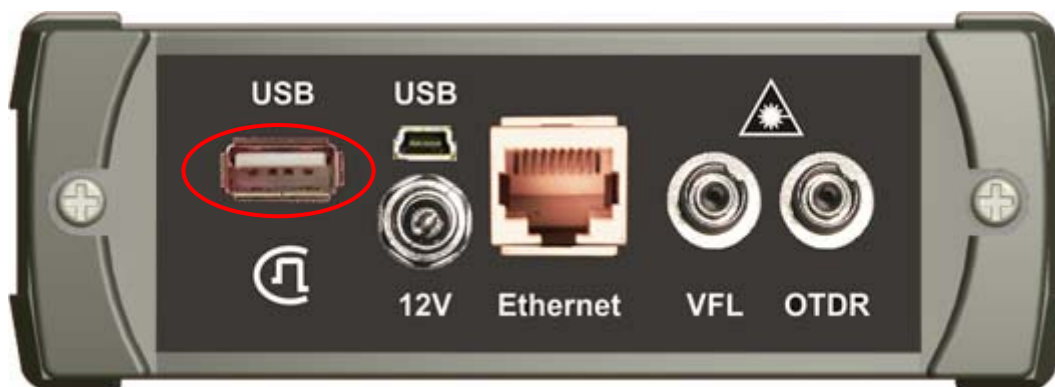
Рис. 35. Подключение Flash накопителя
